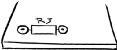
COMO LA PALABRA "RESISTENCIA" EMPIEZA CON LA LETRA "R", LA PCB INDICA, NORMALMENTE CON UNA "R", EL LUGAR DONDE VA CADA UNA DE LAS RESISTENCIAS, SEGUIDA DEL NÚMERO DE LA RESISTENCIA (P. EJ. "R3")
