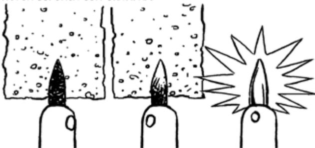
ESTO DEBERÍA DEJAR LA PUNTA PLATEADA Y BRILLANTE, LISTA PARA SEGUIR SOLDANDO. ACUÉRDATE DE LIMPIAR LA PUNTA DE ESTA MANERA, ANTES DE CADA CONEXIÓN. LAS PUNTAS SE OXIDAN RÁPIDAMENTE. SOLO CONSEGUIRÁS HACER UNAS BUENAS CONEXIONES, SI TIENES LA PUNTA BIEN LIMPIA.
