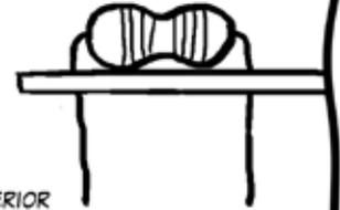
EN LA MAYORÍA DE LAS PCBs, LOS COMPONENTES SE INTRODUCEN A TRAVÉS DE LOS AGUJEROS DE LA PCB PARA QUE QUEDEN POR EL LADO IMPRESO (AL QUE VAMOS A LLAMAR PARTE SUPERIOR DE LA PLACA) Y SE VAN A SOLDAR EN LA PARTE INFERIOR DE LA PLACA.
