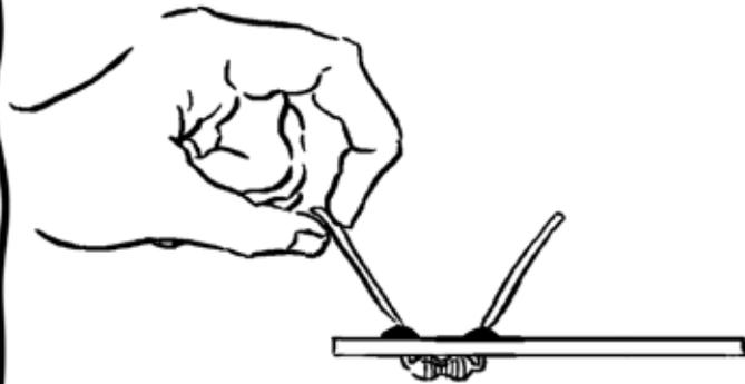
SI EL TROZO DE TERMINAL SOBRENTE ES DEMASIADO CORTO COMO PARA SUJETARLO CON LA MANO, PERO LO SUFICIENTEMENTE LARGO COMO PARA HACER UN CORTO, CUANDO VAYAS A CORTARLO PON TU MANO SOBRE EL TERMINAL.
