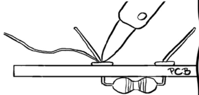
NO AÑADAS EL ESTAÑO SOBRE LA PUNTA, YA QUE ESO LO DERRITE SOLO SOBRE LA PUNTA, DONDE NO SIRVE DE NADA. QUEREMOS QUE EL ESTAÑO FLUIA CORRECTAMENTE ALREDEDOR DE LA ISLA Y EL TERMINAL PARA LOGRAR UNA BUENA CONEXIÓN.
